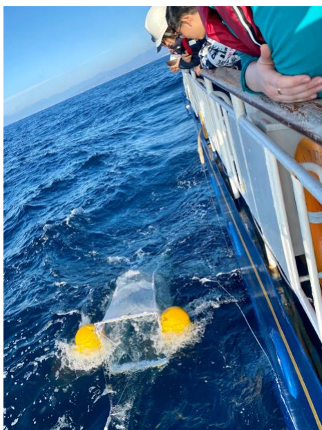
図3 (左)ニューストーンネットによる採集の様子。(下)サンプルの例。表面にマイクロプラスチックと考えられる粒子が目視できる(白色の粒子)。
